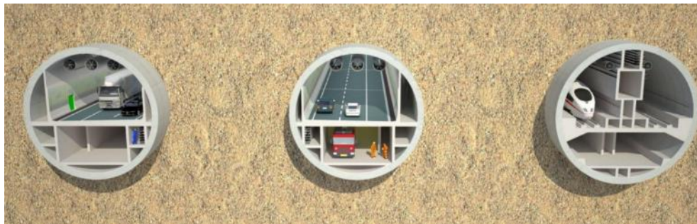
Figur 3-8 Boret tunnel tværsnit 4+2
