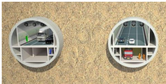
Figur 3-9 Boret tunnel tværsnit 4+0
