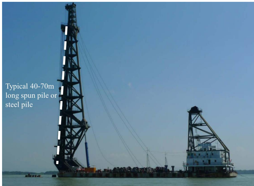
Figur 2-9 Forslag til pram til ramning af pæle (foto: [8])
