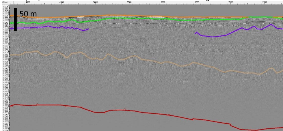
Figur 5-18 U91 i seismisk profil. U91 er defineret at den lysebrune tolkningslinje ved top-reflektoren. Bunden af U91 er en mørkerød tolkningslinje.
