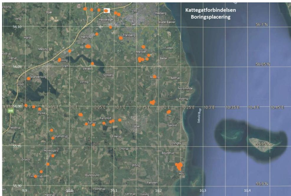
*Figur 4-55 Placing af de digitaliserede borer, der indgår i datagrundlaget for evaluering af de forskellige geotekniske parametre i Jylland.*
