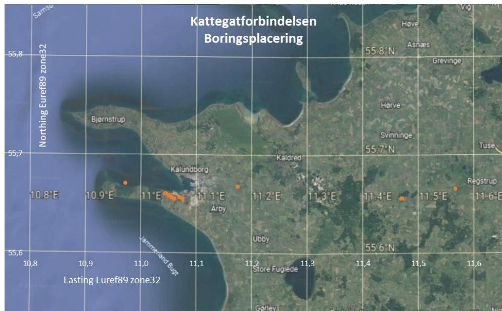
Figur 4-30 Glaciale smeltevandsler og -silt er truffet i de markerede borer.
